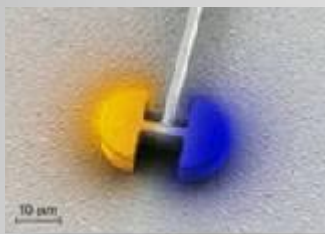
Резонансный контур лазера с двумя полукруглыми лазерами
