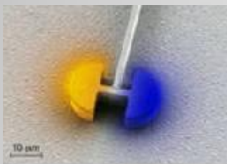
Резонансный контур лазера с двумя полукруглыми лазерами
