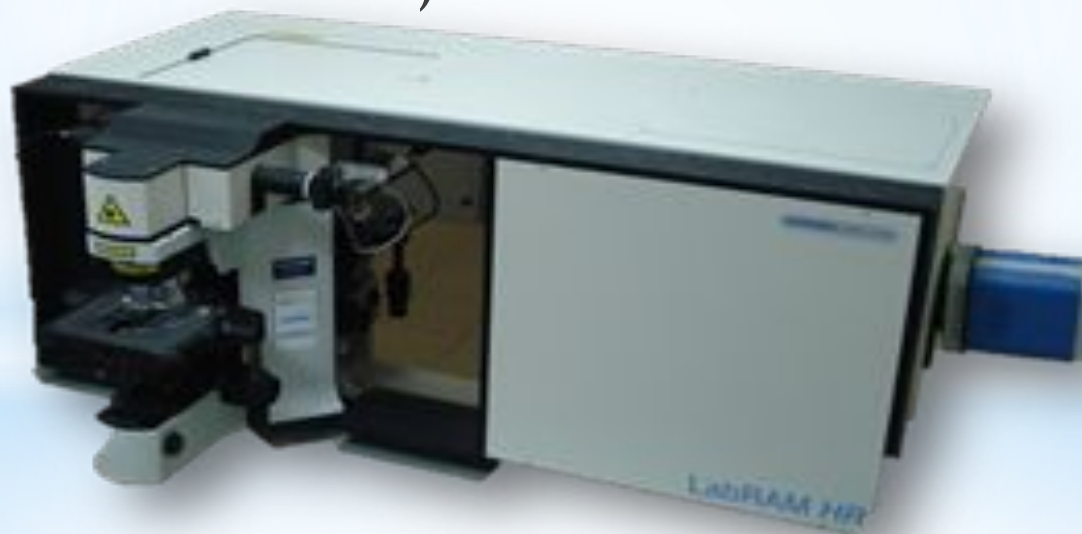
Рис. 6 Внешний вид спектрометра КРС LabRam HR800
