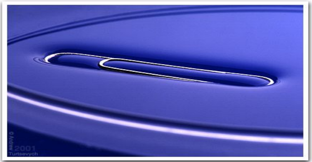
Скрепка, плавающая на поверхности жидкости. Ее удерживают силы поверхностного натяжения.
