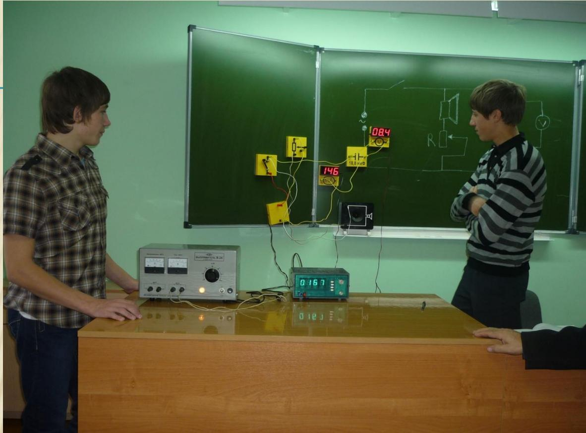
Конденсатор подключен к источнику питания переменного напряжения, ток измеряется цифровым миллиамперметром, а напряжение цифровым вольтметром. Динамик служит для определения на слух частоты напряжения питания. Переменный резистор служит для регулирования громкости звука. Частота  $v = 20$  кГц , а уровень выходного сигнала – близкий к максимальному.
