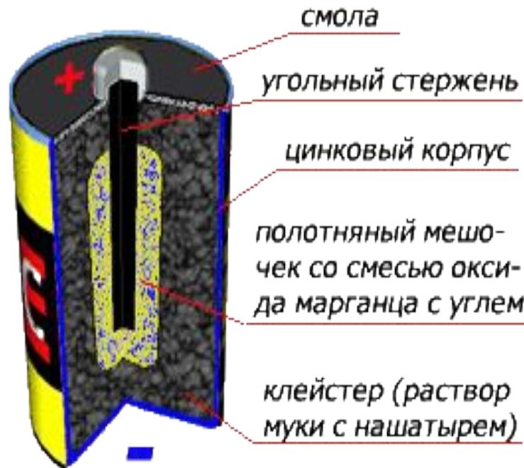
**Гальванический элемент** – химический источник тока, в котором электрическая энергия вырабатывается в результате прямого преобразования химической энергии окислительно-восстановительной реакцией.
