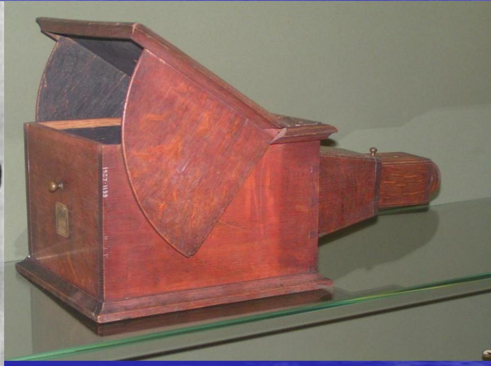
Венецианец Д. Барбаро впервые дал описание камеры-обскуры с плосковыпуклой линзой, позволяющей увеличить действующее отверстие для проникающих в камеру лучей и усилить яркость оптического изображения, получаемого с его помощью.
