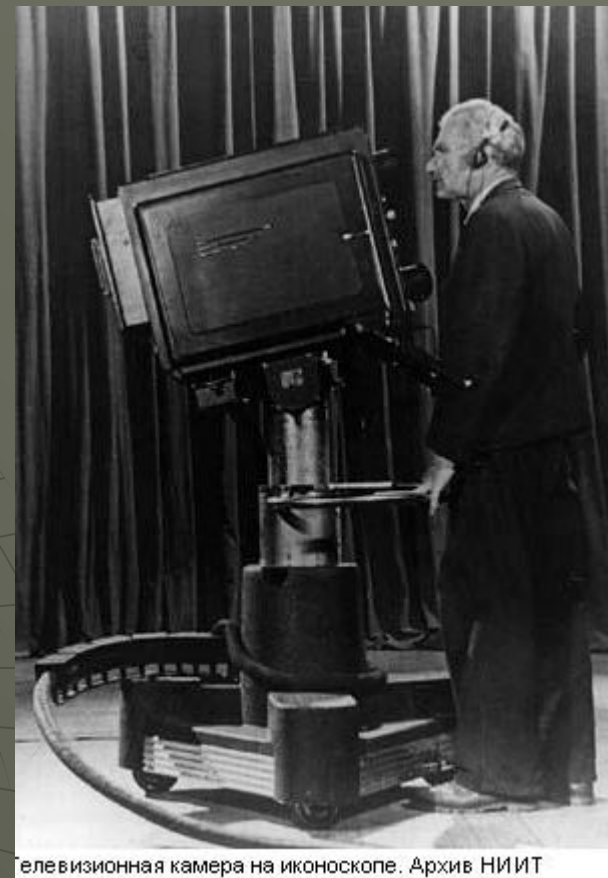
Телевизионная камера на иконоскопе. Архив НИИТ
