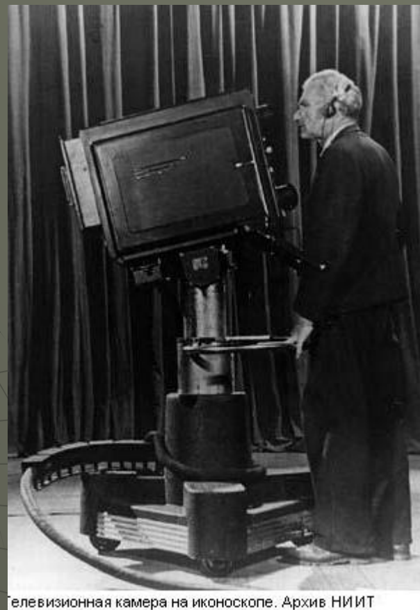
Телевизионная камера на иконоскопе. Архив НИИТ
