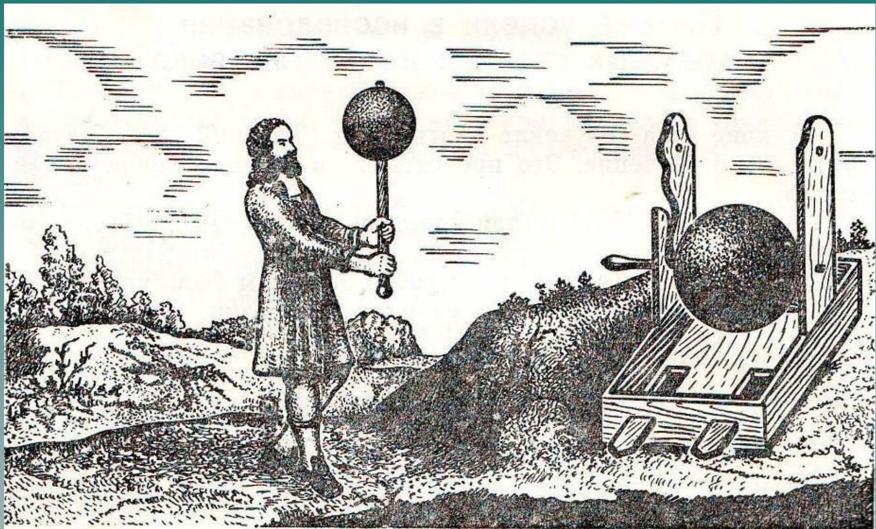
В 1672 г. вышла его книга, в которой были описаны опыты по электричеству. Наиболее интересным достижением Герике было изобретение им «электрической машины». «Электрическая машина» представляла собой шар, сделанный из серы и посаженный на железный шест. Герике вращал этот шар и натирал его ладонью руки. Впоследствии ученый несколько раз усовершенствовал свою «машину»,
