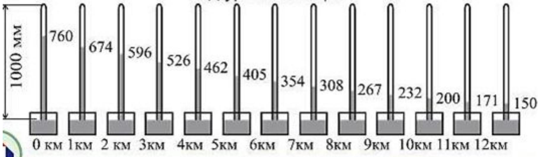
$$P = \rho g h = 13\,600 \text{ кг/м}^3 \cdot 9,8 \text{ Н/кг} \cdot \underline{0,760 \text{ м}} = \underline{101\,300 \text{ Па}}$$
