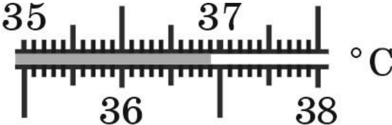
Какую максимальную температуру показывает термометр, изображенный на рисунке, с учетом погрешности измерений?
