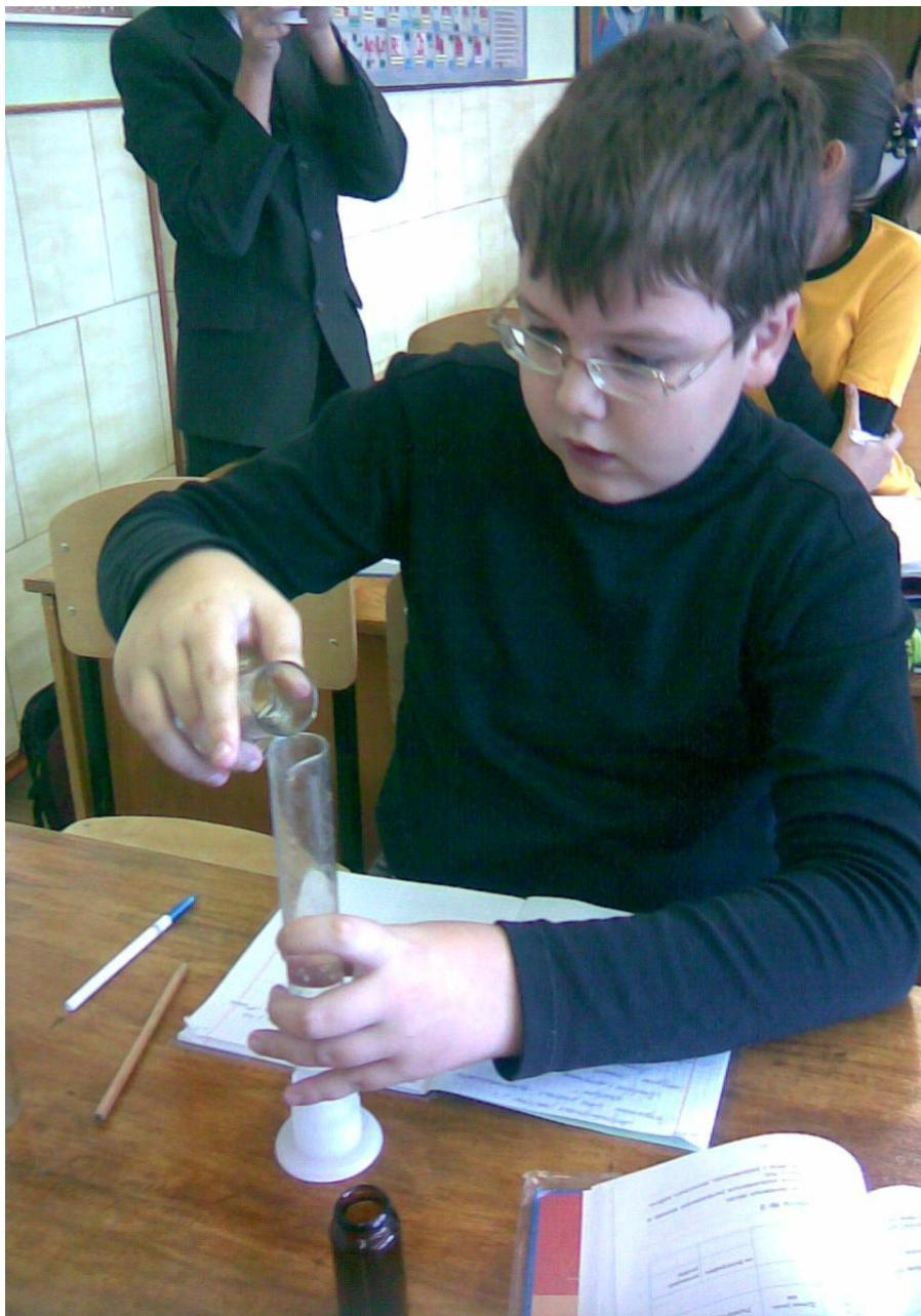
Прежде чем измерять физическую величину каким-либо прибором, нужно обязательно определить цену деления этого прибора
