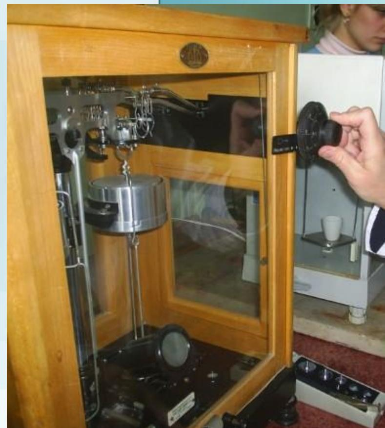
Аналитические весы допускают взвешивание тел не больше определенного предельного веса. Эта предельная нагрузка либо указывается на самих весах или в их паспорте, либо может быть определена, как суммарный вес приложенного к весам разновеса.
