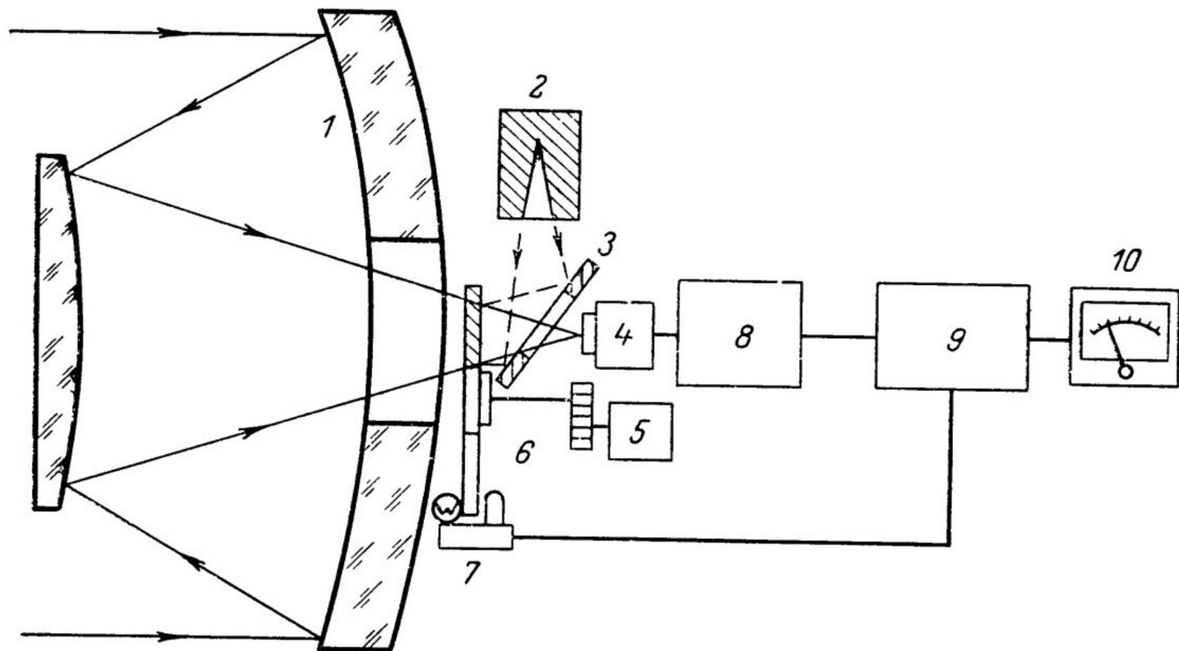
Рис. 1. Схема ИК радиометра.
