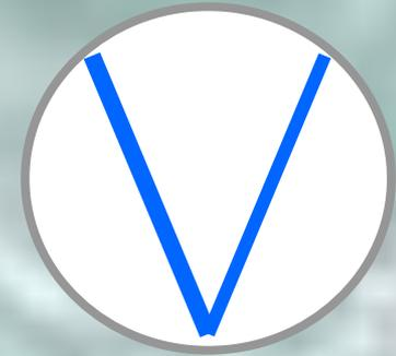
Вольтметр в отличии от амперметра включается в цепь параллельно!!!
