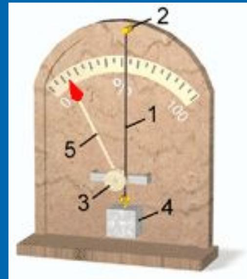
Волосяной гигрометр, в котором деталь, чувствительной к изменению влажности, служит обезжиренный человеческий волос [1]. Он закреплен в верхней части прибора [2], обернут вокруг ролика [3] и натянут при помощи специально подобранного груза [4]. К ролику прикреплена стрелка [5]. При увеличении относительной влажности воздуха волос удлиняется и вызывает вращение ролика вместе со стрелкой. Стрелка, передвигаясь по шкале, указывает значение влажности воздуха, выраженное в процентах.
