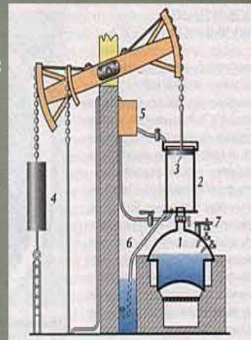
После этого двигатель вновь был готов к следующему впрыскиванию пара. Основной недостаток машины Ньюкомена состоял в том, что рабочий цилиндр в ней являлся в то же время и конденсатором. Из-за этого приходилось поочередно то охлаждать, то нагревать цилиндр, и расход топлива оказывался очень велик.
