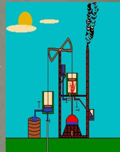
Последующие изобретатели внесли много усовершенствований в насос Ньюкомена. Но принципиальная схема машины Ньюкомена оставалась неизменна на протяжении 50 лет.
