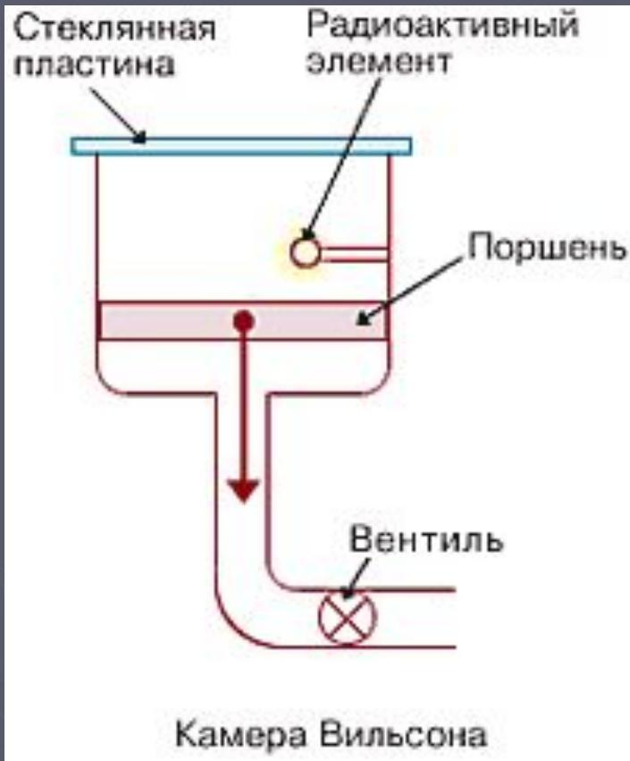
► Принцип действия камеры использует явление конденсации перенасыщенного пара: при появлении в среде перенасыщенного пара каких-либо центров конденсации (в частности ионов, сопровождающих след быстрой заряженной частицы) на них образуются мелкие капли жидкости. Эти капли достигают значительных размеров и могут быть сфотографированы. Источник исследуемых частиц может располагаться либо внутри камеры, либо вне ее (в этом случае частицы залетают через прозрачное для них окно).
