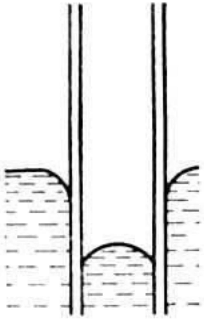
Отрицательное капиллярное давление оказывает стягивающее действие на ограничивающие жидкость стенки (**рис. 2, б**). Это может приводить к значительной объёмной деформации высокодисперсных систем и пористых тел — капиллярной контракции. (Дисперсность - величина, показывающая какое число частиц можно уложить вплотную в одном метре. Чем меньше размер частиц, тем больше дисперсность). Так, например, происходящий при высушивании рост капиллярного давления приводит к значительной усадке материалов.
