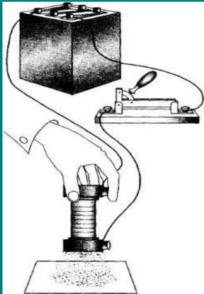
Это катушка, состоящая из большого числа витков провода, намотанного на деревянный каркас. Когда в катушке есть ток, железные опилки притягиваются к ее концам, при отключении тока они падают.
