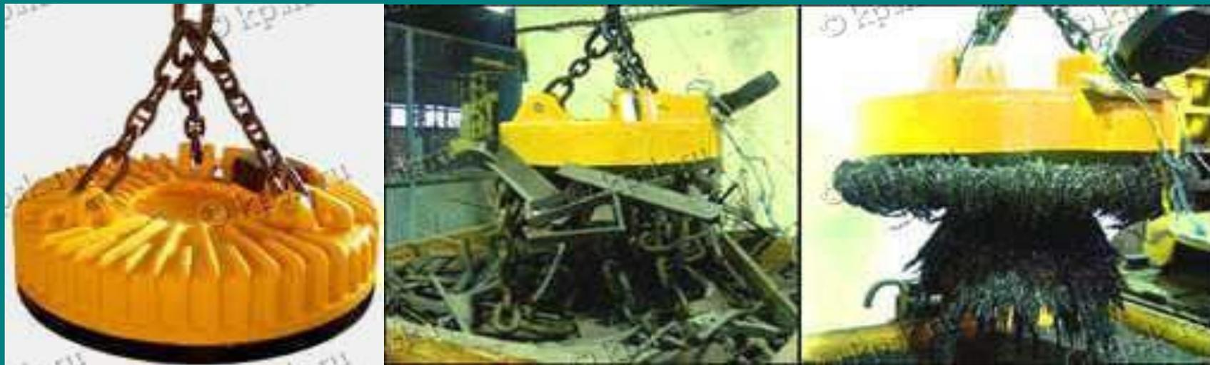
**Электромагниты, обладающие большой подъемной силой, используют на заводах для переноски изделий из стали или чугуна, а также стальных и чугунных стружек, слитков.**
