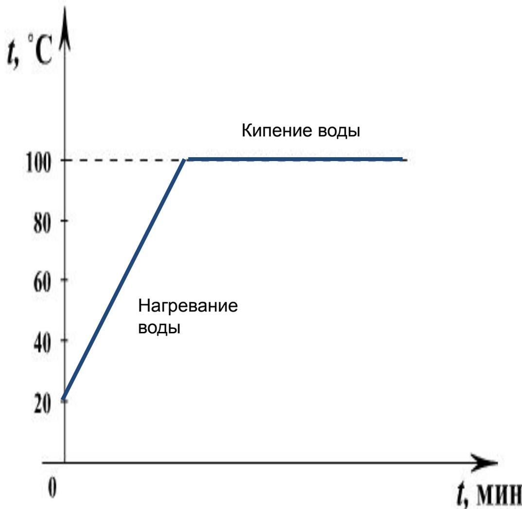
Для воды, при нормальных условиях,  $t_k = 100^\circ\text{C}$
