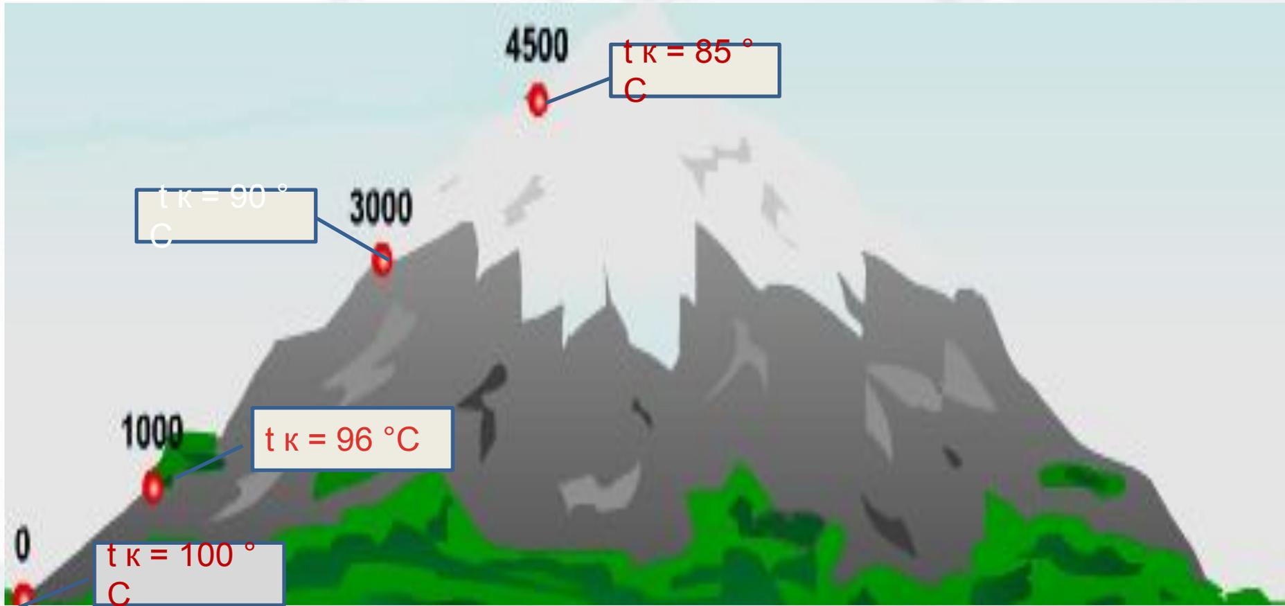
При подъёме в горы атмосферное давление уменьшается, поэтому понижается температура кипения воды, приблизительно на  $1^\circ\text{C}$  на каждые 300 м высоты
