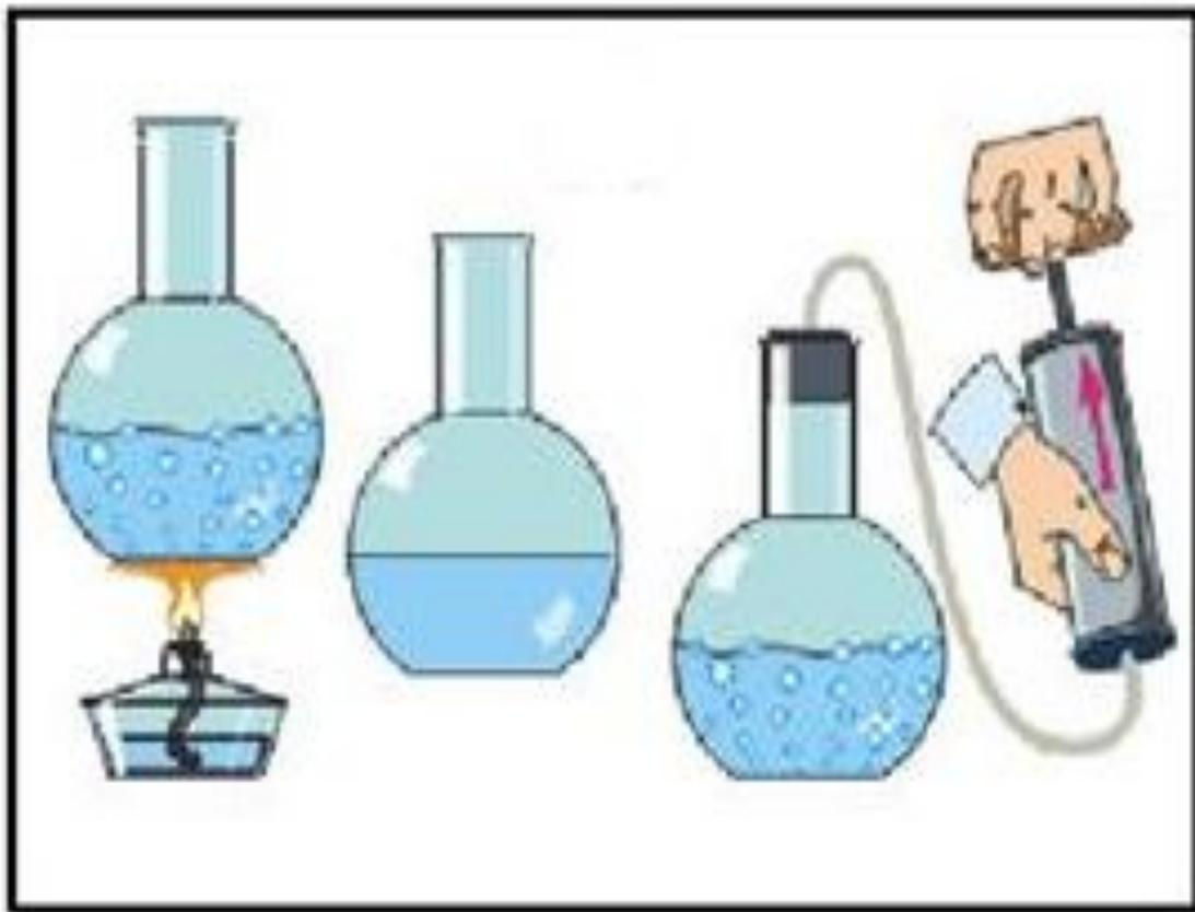
Откачивая воздух с помощью насоса, можно заставить кипеть воду при комнатной температуре!
