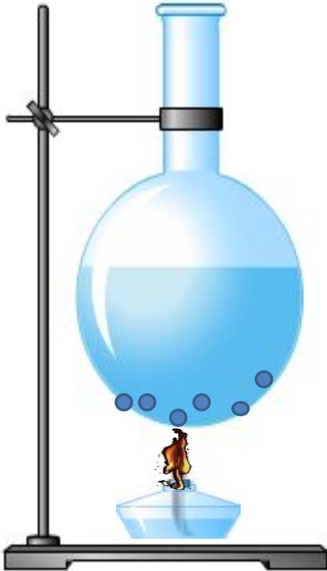
Жидкость прогревается неравномерно. В верхних, более холодных слоях, пузырьки охлаждаются, объём их резко уменьшается – они «захлопываются». Мы слышим шум.
