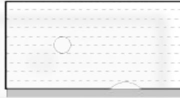
Достигнув определенных размеров он отрывается от дна, поднимается к поверхности воды и лопаается. При этом пар покидает жидкость. Если вода прогрета недостаточно, то пузырек пара, поднимаясь в холодные слои, схлопывается. Возникающие при этом колебания воды приводят к появлению во всем объеме воды огромного количества мелких пузырьков воздуха: так называемый "белый ключ".
