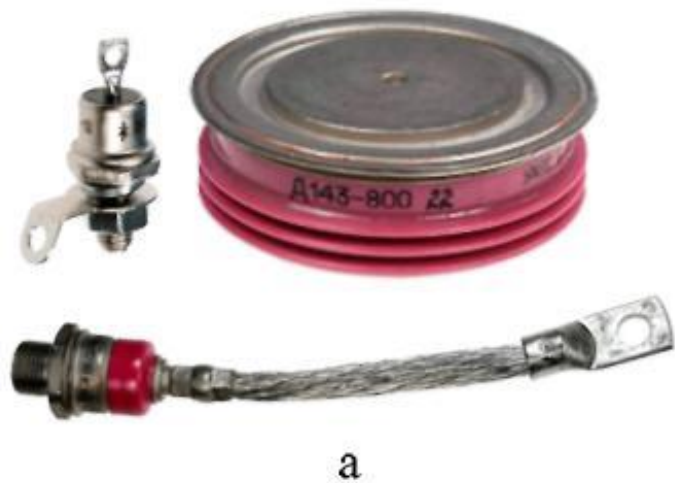
Мощные выпрямительные диоды: а) дискретного исполнения; б) диодные силовые модули; в) конструкция силового диода
