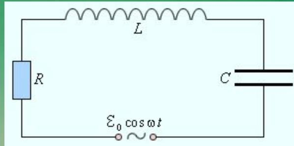
**Полное сопротивление колебательного контура переменному току зависит от частоты тока**
