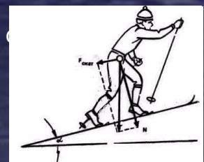
Рис. 30. Действие сил на лыжника на подъеме
