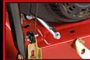
ТРУБКА ДЛЯ БЫСТРОЙ И ЛЕГКОЙ СМЕНЫ МАСЛА ДЕЛАЕТ ОБСЛУЖИВАНИЕ ПРОСТЫМ И ЧИСТЫМ.
