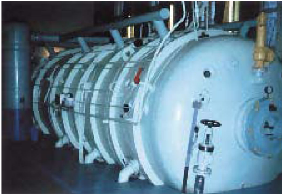
Кріовакуумна установка – імітатор космічного простору для випробування елементів космічних апаратів
