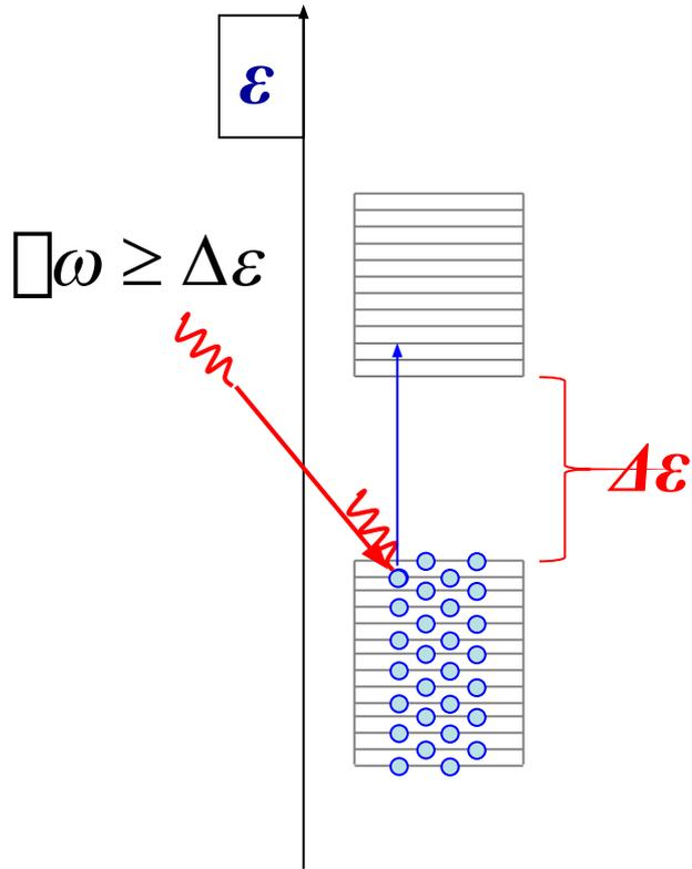
Для изготовления фоторезисторов используют полупроводниковые материалы с шириной запрещенной зоны, оптимальной для решаемой задачи.
