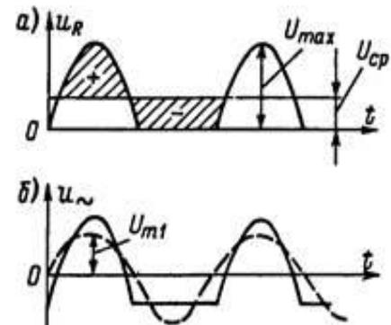
Рис. 3.10. Постоянная и переменная составляющие выпрямленного напряжения
