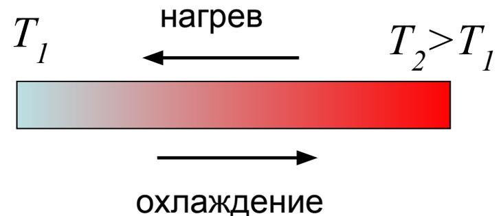
При переходе из одного проводника в другой электроны либо передают избыточную энергию атомам, либо пополняют недостаток энергии за их счёт (в зависимости от направления тока). В первом случае вблизи контакта выделяется, а во втором — поглощается теплота.
