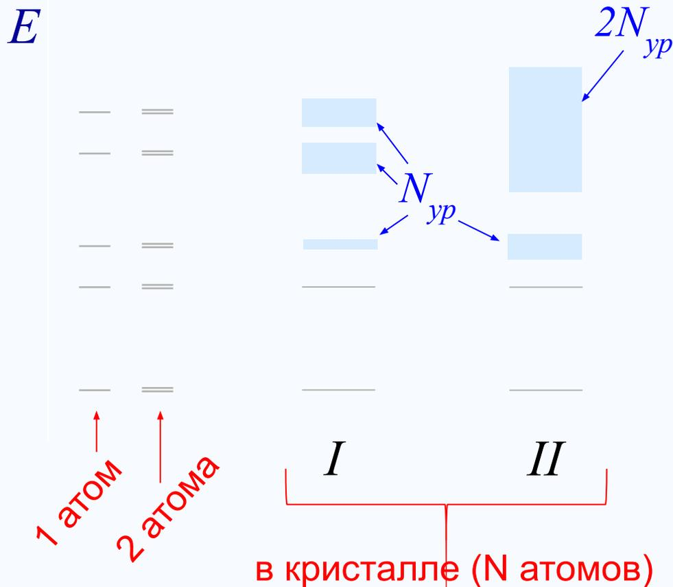
Образование энергетических зон в кристалле (следует из решения уравнения Шредингера для  $e$  в периодическом силовом поле кристалла)
