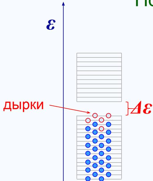
При  $T = 300 \text{ K}$  концентрация электронов в зоне проводимости  $n \sim 10^{17} \text{ 1/м}^3$ , а уд. сопротивление  $\rho \sim 10^3 \text{ Ом} \cdot \text{м}$ ;
