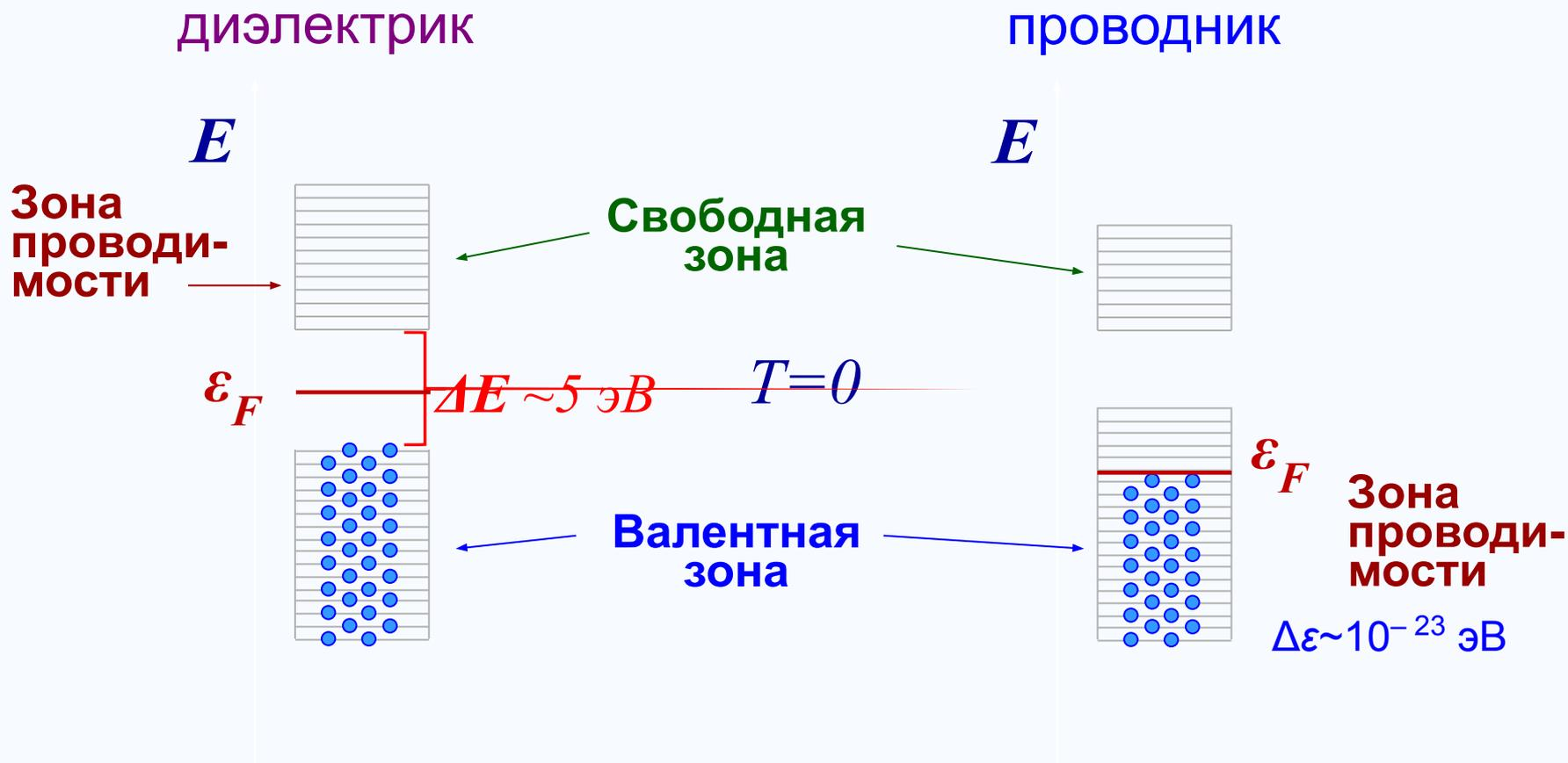
Условие массового термического перехода электронов в зону проводимости диэлектрика:
