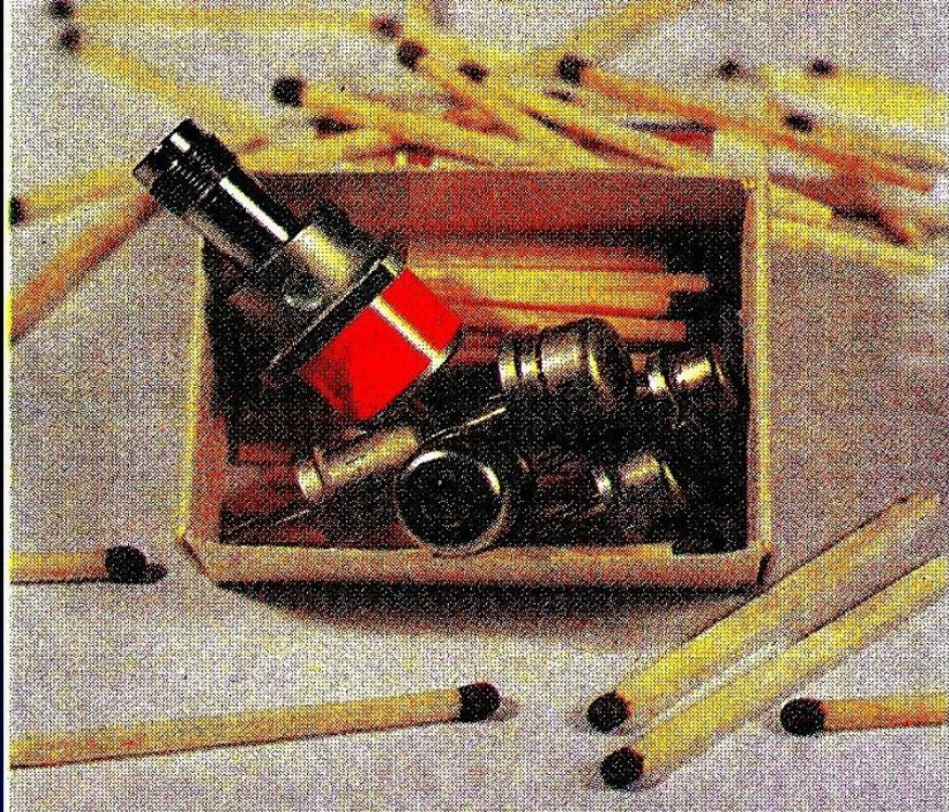
В полупроводниковом лазере излучает слой между двумя полупроводниками Р-и n-типа.
