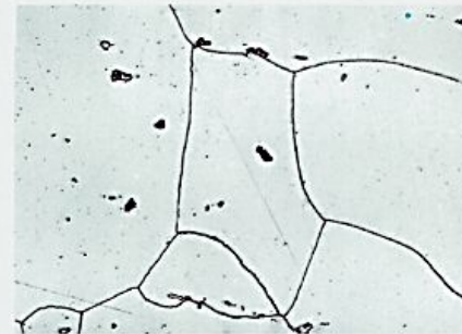
Микроструктура стали 37X12H8Г8МФБ
