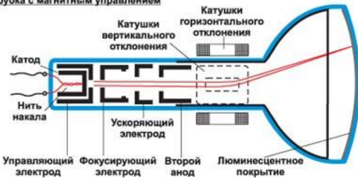
Трубка с магнитным управлением
