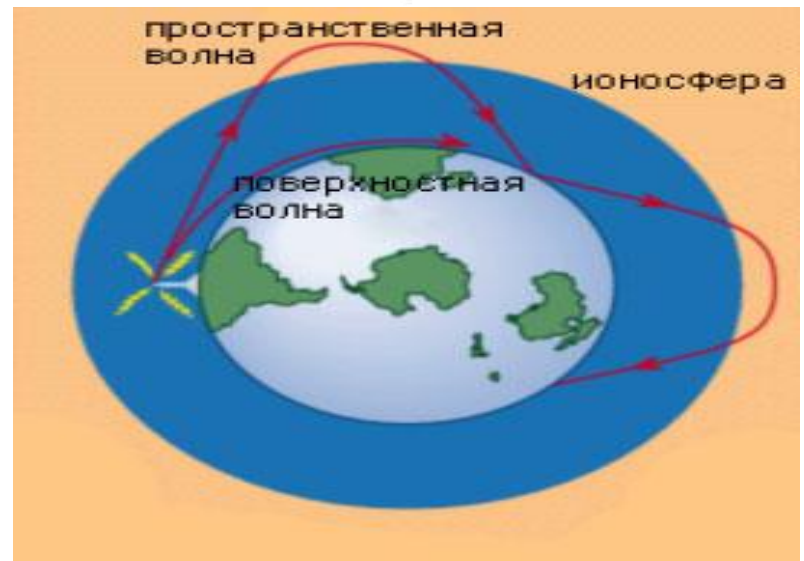
Рис. 4.2. Схема отражения радиоволн
