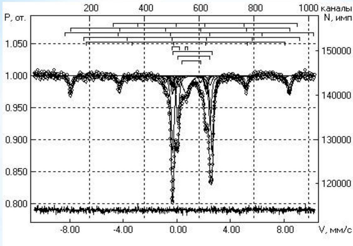
Рис.2. М-спектр ядер  $^{57}\text{Fe}$  в фрагменте №1 метеорита «Челябинский». Условия съёмки: 15.05.12.  $T=323\text{ K}$ . t30\_1S\_1s2a\_CoCr-2014.spc,  $\chi^2 = 1.205$ , качество спектра – 76, погрешность эффекта – 0.013, длительность набора – 16 часов.
