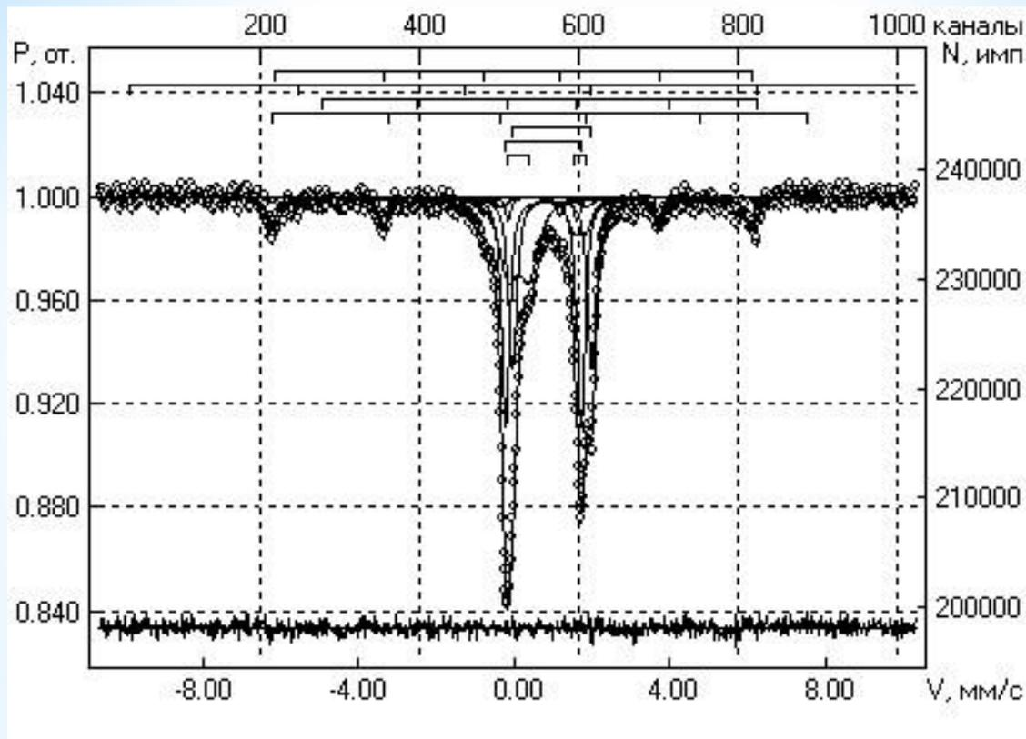
Рис.6. М-спектр ядер  $^{57}\text{Fe}$  в фрагменте №1 метеорита «Челябинский». Условия съёмки: 14.07.10.  $T=723$  К. t30\_1S\_1s2a\_CoCr-2014.spc,  $\chi^2 = 1.249$ , качество спектра – 77, погрешность эффекта – 0.013, длительность набора: 11 часов.
