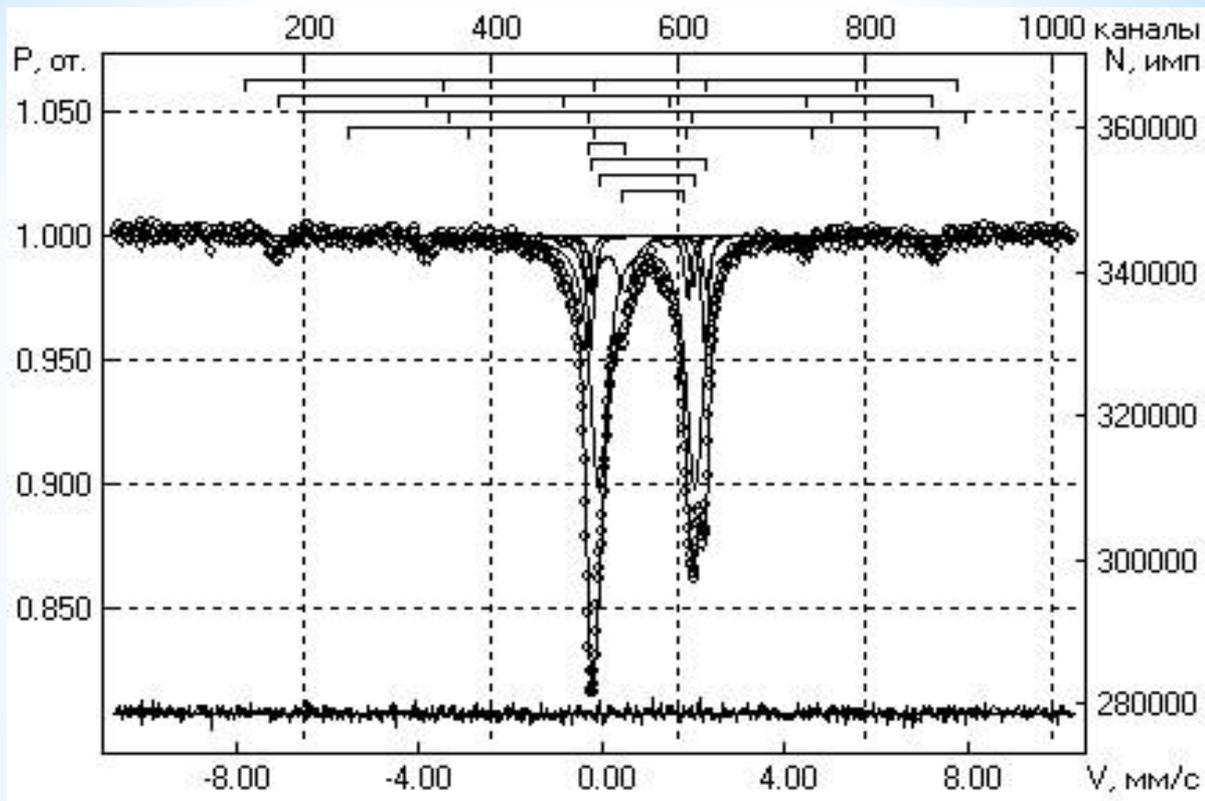
Рис.5. М-спектр ядер  $^{57}\text{Fe}$  в фрагменте №1 метеорита «Челябинский». Условия съёмки: 14.06.14.  $T=573\text{ K}$ . t30\_1S\_1s2a\_CoCr-2014.spc,  $\chi^2 = 1.260$ , качество спектра – 108, погрешность эффекта – 0.009, длительность набора: 17 часов.
