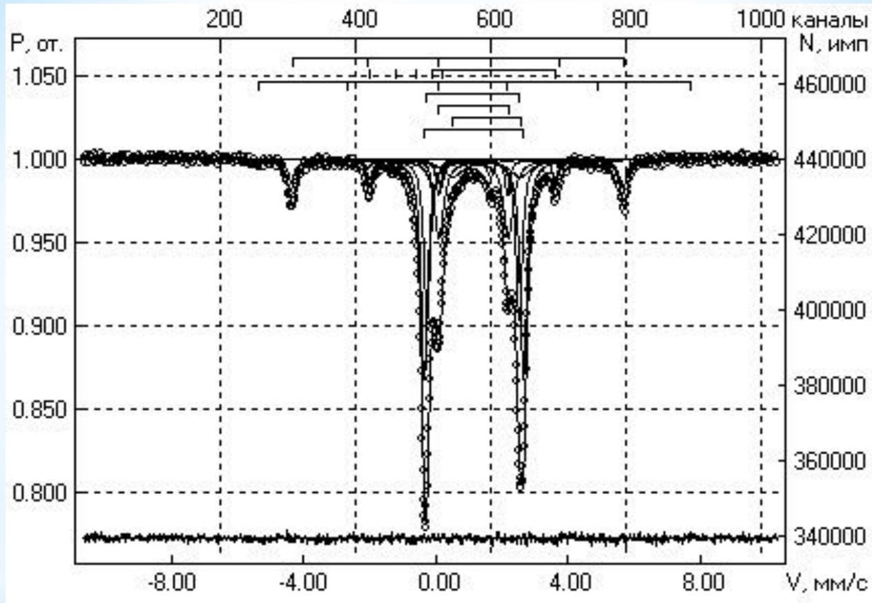
Рис.1. М-спектр ядер  $^{57}\text{Fe}$  в фрагменте №1 метеорита «Челябинский». Условия съёмки:  $\chi^2=1.518$ , 14.06.05.  $T=300$  К\_t30.1S\_1s2a\_CoCr-2014.spc, качество спектра – 148, погрешность эффекта – 0.007, длительность набора – 21 час.
