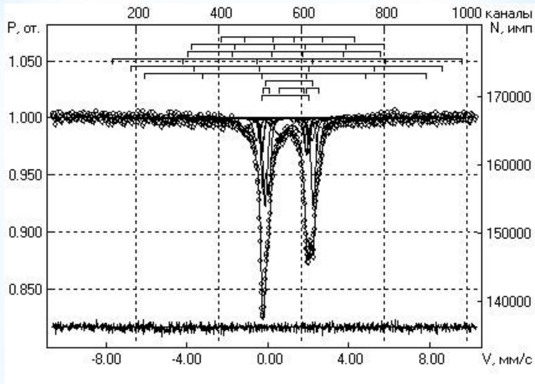
Рис.4. М-спектр ядер  $^{57}\text{Fe}$  в фрагменте №1 метеорита «Челябинский Условия съёмки: 14.06.14.  $T=553$  К.  $t30\_1S\_1s2a\_CoCr-2014.spc$ ,  $\chi^2=1.260$ , качество спектра – 108, погрешность эффекта – 0.009, длительность набора: 17 часов.
