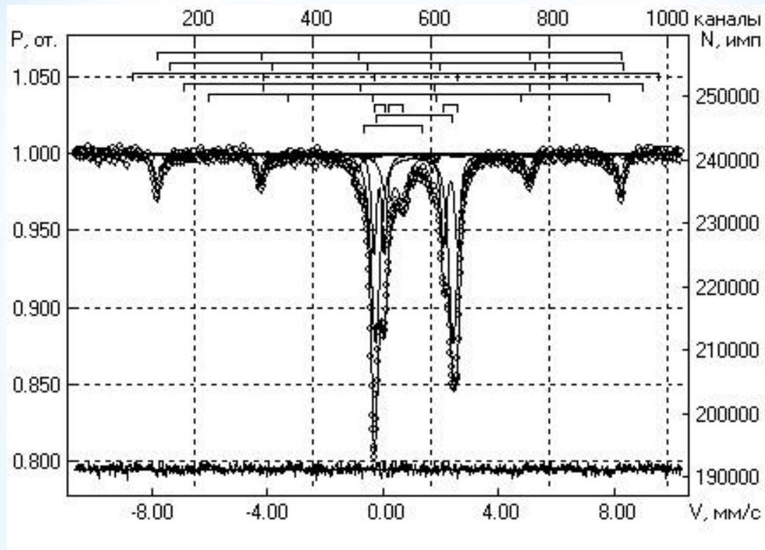
Рис.3. М-спектр ядер  $^{57}\text{Fe}$  в фрагменте №1 метеорита «Челябинский». Условия съёмки: 15.05.14.  $T=373$  К. t30\_1S\_1s2a\_CoCr-2014.spc,  $\chi^2 = 1.414$ , качество спектра – 97, погрешность эффекта–0.010, длительность набора: 26 часов.
