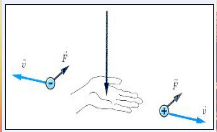
*Правило: если левую руку расположить так, чтобы линии магнитного поля входили в ладонь перпендикулярно к ней, а четыре пальца были направлены по движению положительно заряженной частицы (или против движения отрицательно заряженной), то отставленный на 90° большой палец покажет направление действующей на частицу силы.*
