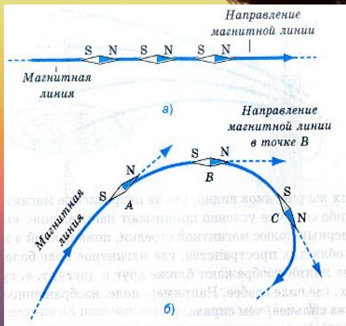
Поскольку электрический ток – это направленное движение заряженных частиц, то можно сказать, что магнитное поле создается движущимися заряженными частицами, как положительными, так и отрицательными. Для наглядного представления магнитного поля мы пользовались магнитными линиями. Магнитные линии – это воображаемые линии, вдоль которых расположились бы маленькие магнитные стрелки, помещенные в магнитное поле.
