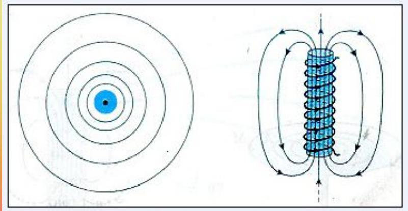
Сила, с которой поле полосового магнита действует на помещенную в это поле магнитную стрелку, в разных точках поля может быть различной как по модулю, так и по направлению. Такое поле называют *неоднородным*. Линии неоднородного магнитного поля искривлены, их густота меняется от точки к точке. В некоторой ограниченной области пространства можно создать *однородное* магнитное поле, т.е. поле, в любой точке которого сила действия на магнитную стрелку одинакова по модулю и направлению.
