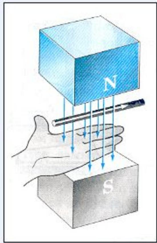
Направление силы, действующей на проводник с током в магнитном поле, можно определить, пользуясь правилом левой руки. Если левую руку расположить так, чтобы линии магнитного поля входили в ладонь перпендикулярно к ней, а четыре пальца были направлены по току. То отставленный на  $90^{\circ}$  большой палец покажет направление действующей на проводник силы.
