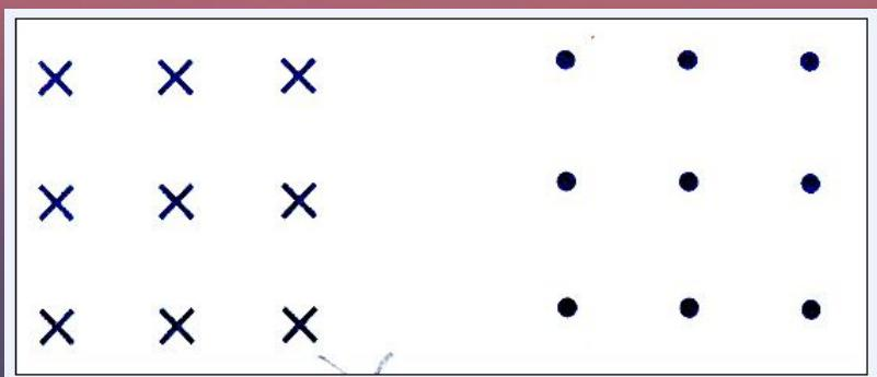
Для изображения магнитного поля пользуются следующим приемом. Если линии однородного магнитного поля расположены перпендикулярно к плоскости чертежа и наплавлены от нас за чертеж, то их изображают крестиками, а если из-за чертежа к нам – то точками.
