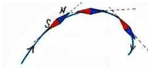
Вне магнита магнитные линии выходят из северного полюса магнита и входят в южный, замыкаясь внутри магнита.
