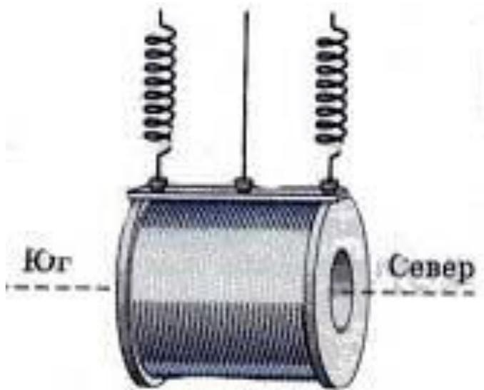
Конец соленоида, из которого магнитные линии выходят, становится **северным полюсом**, а другой конец, в который магнитные линии входят, - **южным полюсом** магнита-соленоида.
