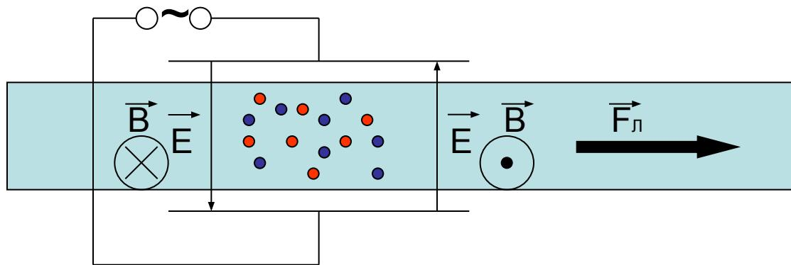
Такое устройство будет работать только при крайне высоких частотах (порядка  $10^{11}\text{Гц}$ ).
