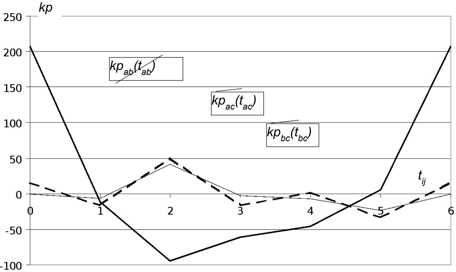
Схема размещения во времени моментов включения электроприемников  $a$ ,  $b$ ,  $c$ .
