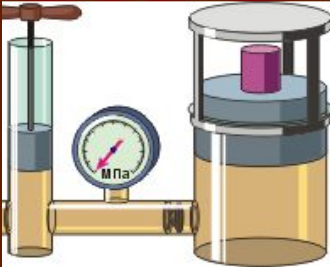
Схема гидравлического прессы
