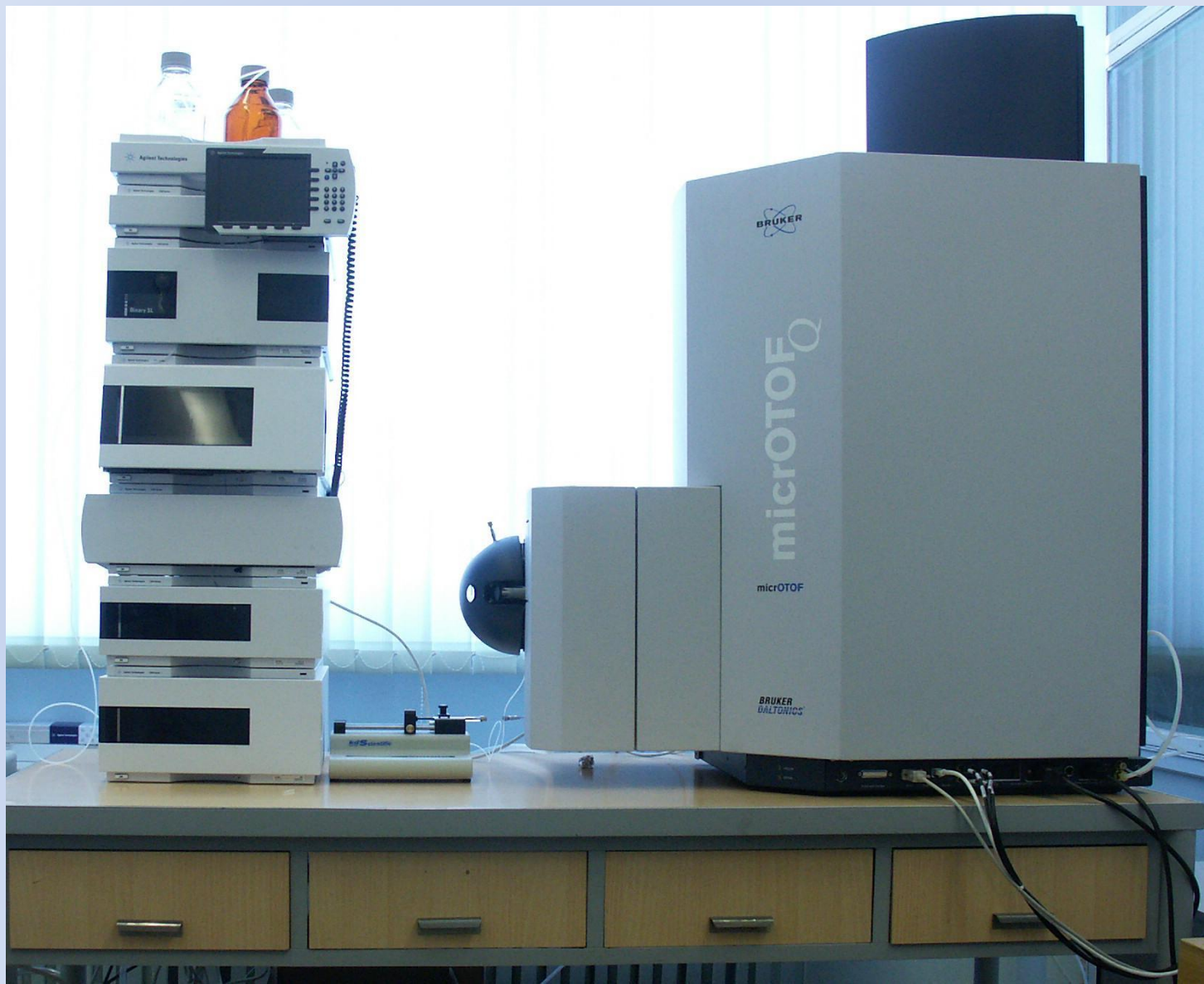
Рис. Времяпролетный масс-спектрометр высокого разрешения Bruker \text{microTOF}_Q с жидкостным хроматографом Agilent 1100
