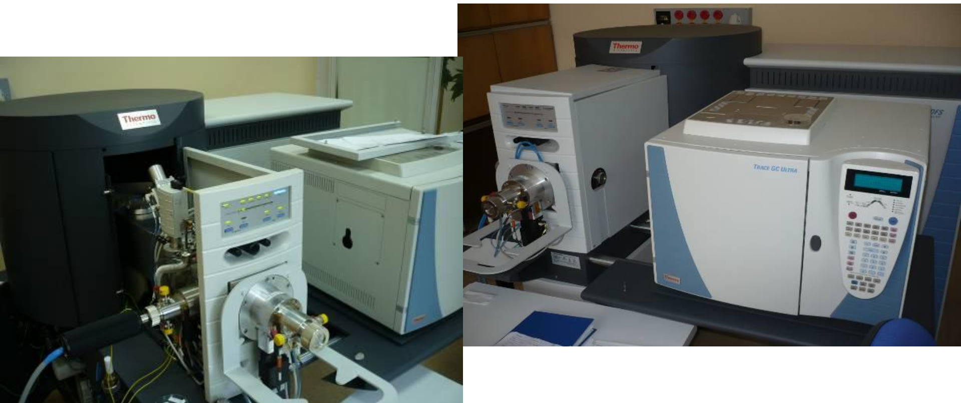
Рис. Масс-спектрометр высокого разрешения Thermo Electron DFS с газовым хроматографом Thermo Electron Trace GC Ultra
