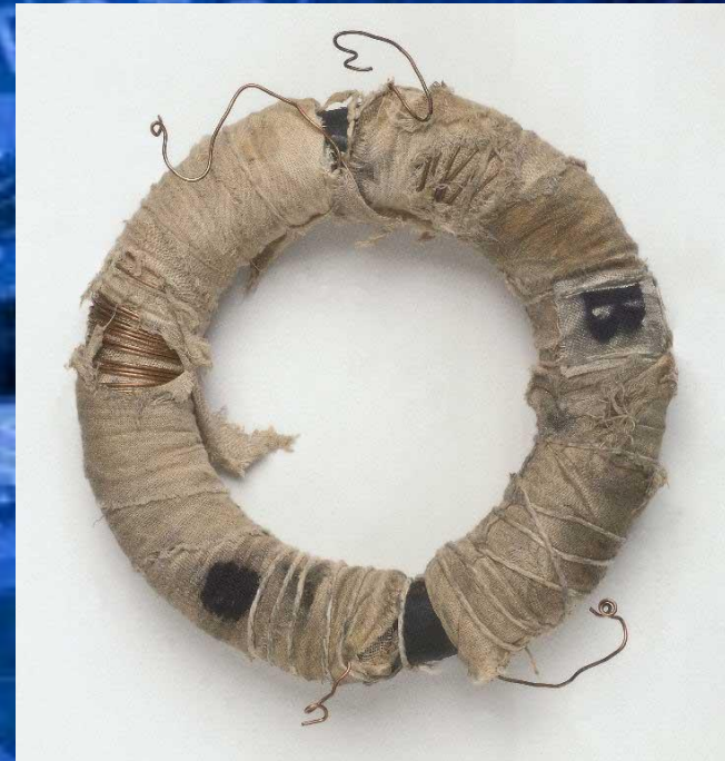
Прибор Фарадея для наблюдения электромагнитной индукции...
