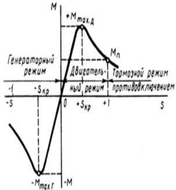
Рис. 13.2. Зависимость режимов работы асинхронной машины от скольжения
