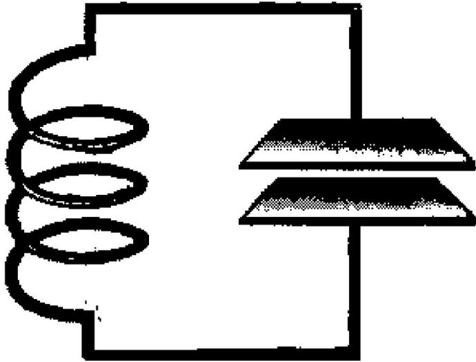
Система колебательного контура
