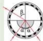
Отражение света при переходе из оптически более плотной среды в менее плотную
