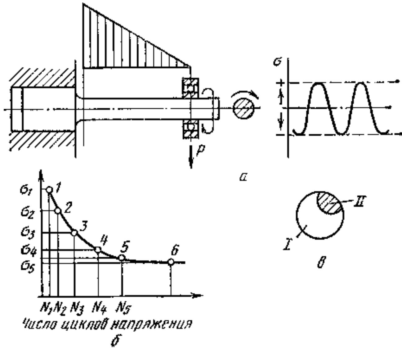
Испытания на усталость (а), кривая усталости (б)
