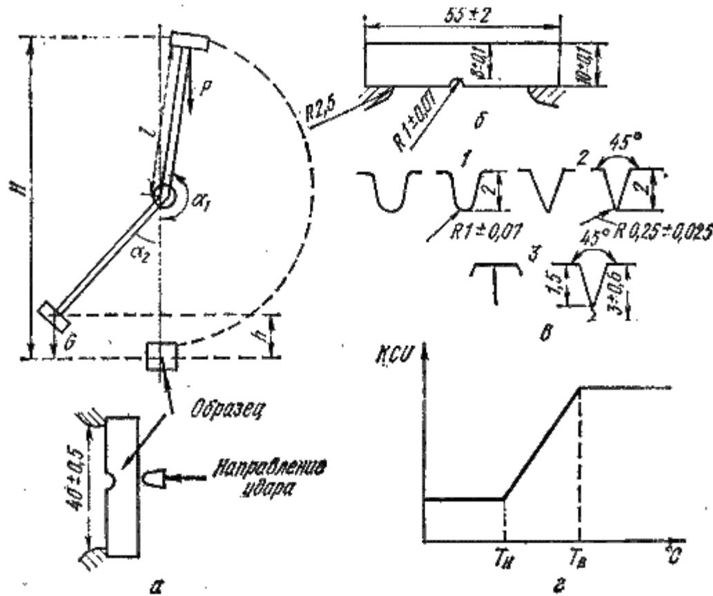
На разрушение образца затрачивается
