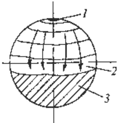
Схема зарождения и развития трещины при переменном изгибе круглого образца
