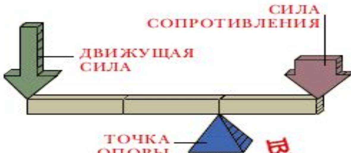
Движущая сила и сила сопротивления приложены по разные стороны от точки опоры. Чем меньше плечо силы сопротивления, тем меньше может быть движущая сила. Пример такого рычага — гвоздодер.
