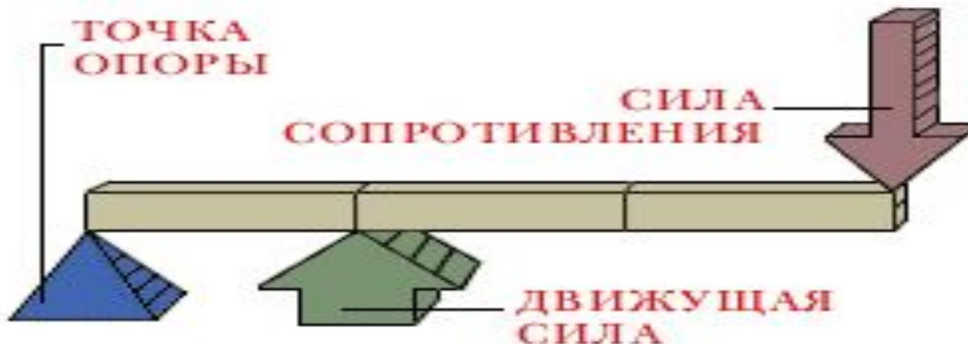
Точка опоры — на одном конце рычага, а точка приложения (малой) **силы сопротивления** — на другом. Такой рычаг служит «усилителем» малого
