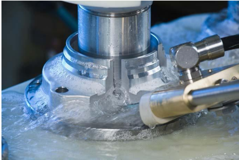
Рисунок 22.11- ЕМАГ ЕСМ – Удаление заусенцев ЭХ методом
