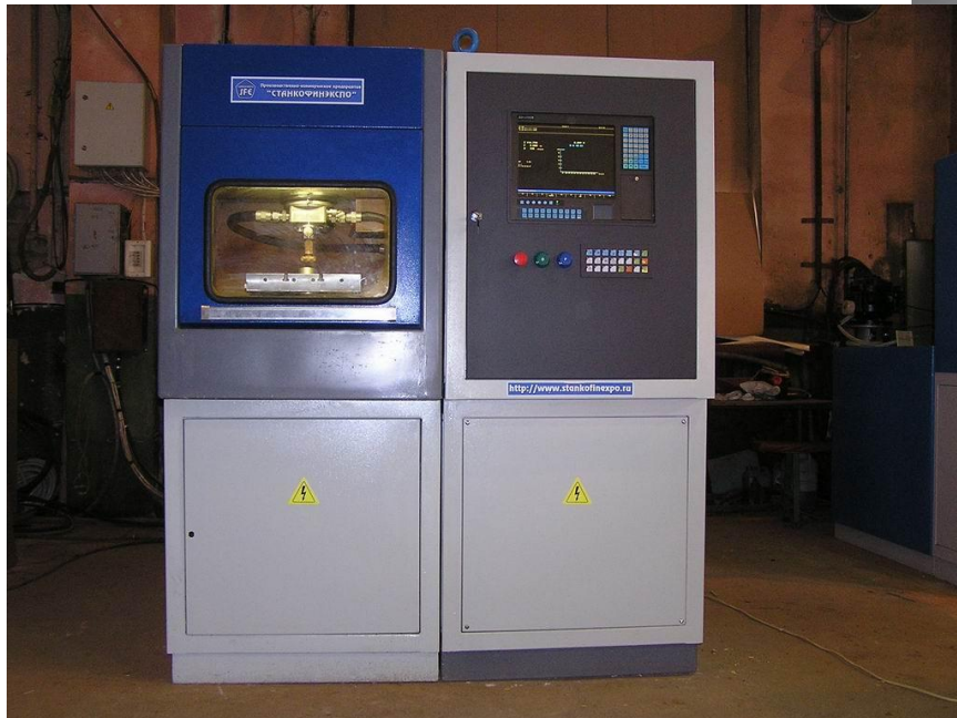
Рисунок 22.9-Станки SFE для прецизионной электрохимической обработки
