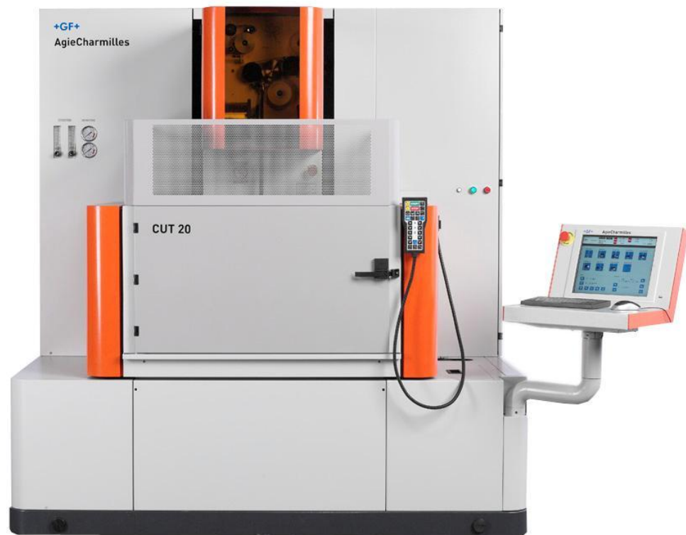
Рисунок 22.5- Электроэрозионный проволочно-вырезной станок AGIE CHARMILLES CUT 20
