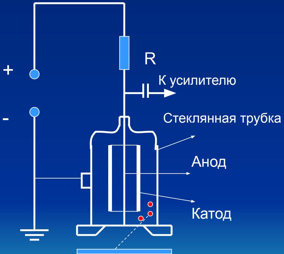
В газоразрядном счетчике имеются катод в виде цилиндра и анод в виде тонкой проволоки по оси цилиндра. Пространство между катодом и анодом заполняется специальной смесью газов. Между катодом и анодом прикладывается напряжение.
