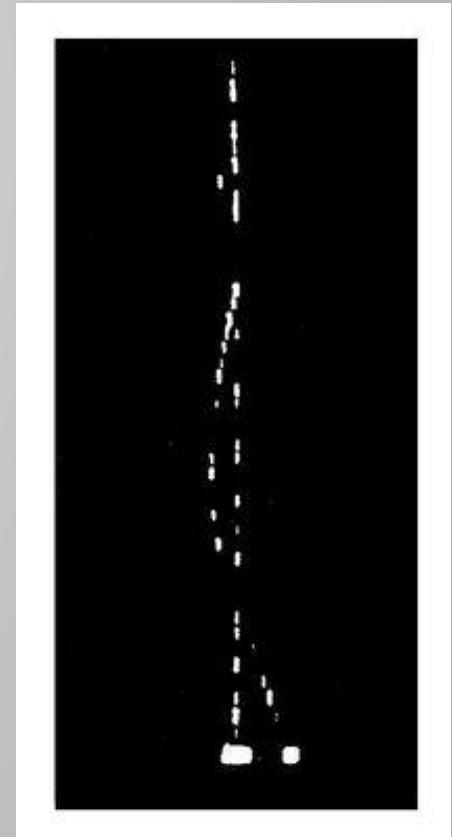
Трек частицы в узкоззорной искровой камере
