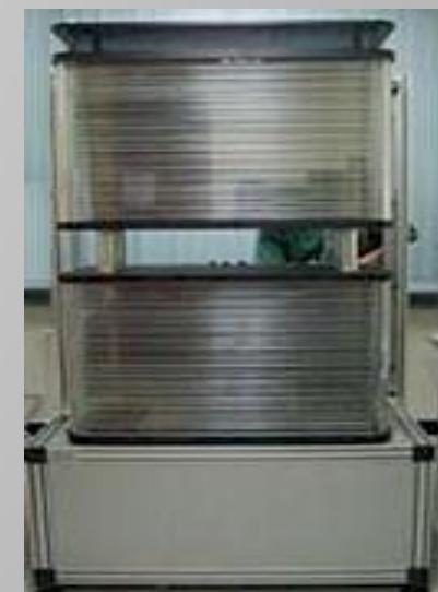
Внешний вид двухсекционной искровой камеры
